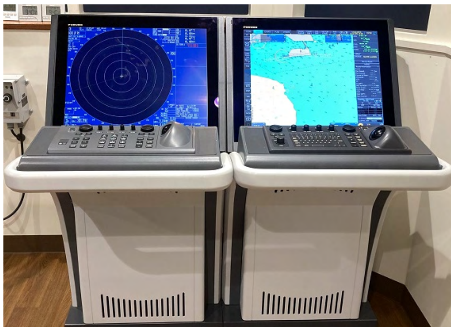
図 6.2: 操船シミュレータの構成【船舶レーダー (左), ECDIS (右)】
