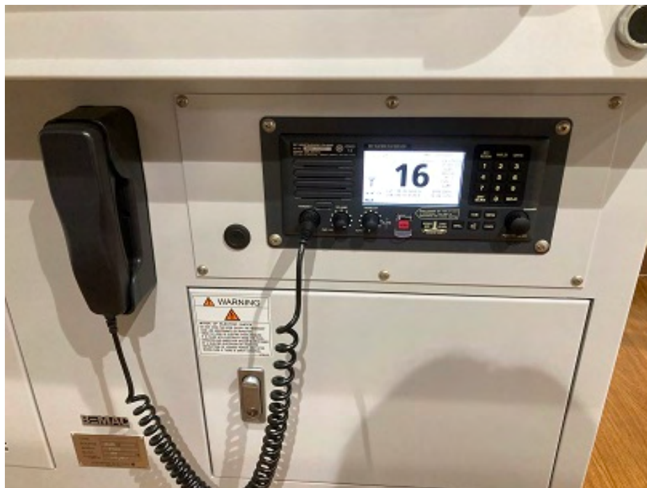
図 6.4: 操船シミュレータの構成【国際 VHF システム】
