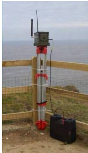
図 4.1: イギリス・フランボロー・ヘッドに設置された GPS ジャマーユニット [52]
