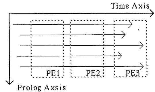
図4 時間軸方向並列、現在軸方向逐次
