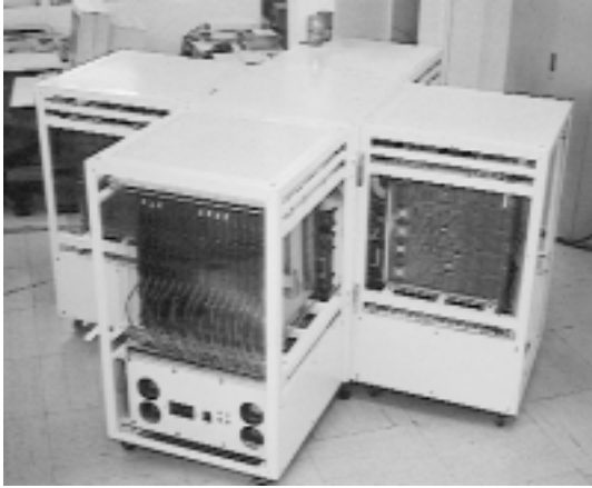
図 1: 並列推論エンジン PIE64. 64 台の推論ユニットと 2 系統の相互結合網を持つ. 自動負荷分散機能を使って, マシン全体の負荷状態判断が容易に可能.
