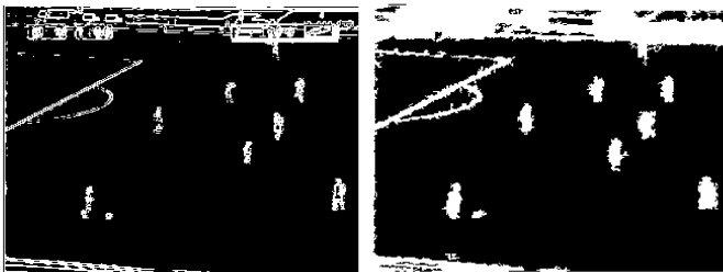
図 2: (左) : Sobel オペレータによる 2 値画像例 (右) : 提案手法による 2 値画像例
